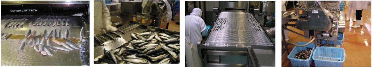
話がバラバラになってしまいますが、イワシを三枚に卸すということは、頭と尻尾を取り、腹骨を取っていない状態で、三枚イワシのフィレーを機械で作る場合です。このようにいわしを並べ、歯が付いていて頭と尻尾をカットして三枚に卸します。三枚卸しにしたものを、急速冷凍します。ステンレスの上に一枚ずつ並べると、この機械だと約40分で凍結します。
